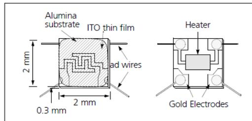
**Fig 1. Sensing Elements**
