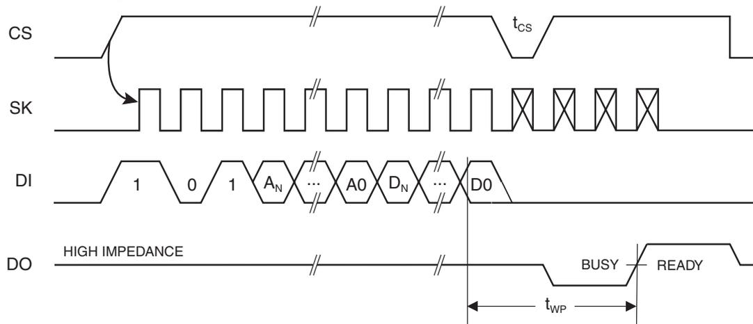
Figure 3-6. WRAL Timing<sup>(1)</sup>
