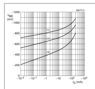
**BC857A;**  $V_{CE} = -5 \text{ V}.$
