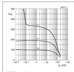
**BC857A;**  $V_{CE} = -5 \text{ V}.$
