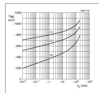
**BC857B;**  $V_{CE} = -5 \text{ V}.$
