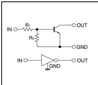
$R_1=47k\Omega$ ,  $R_2=22k\Omega$
