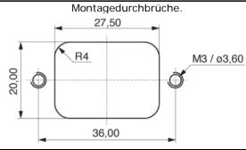
Einbau - Gerätestecker mit Längsflansch.
