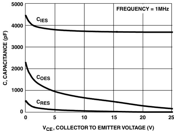
FIGURE 5. CAPACITANCE vs COLLECTOR TO EMITTER VOLTAGE
