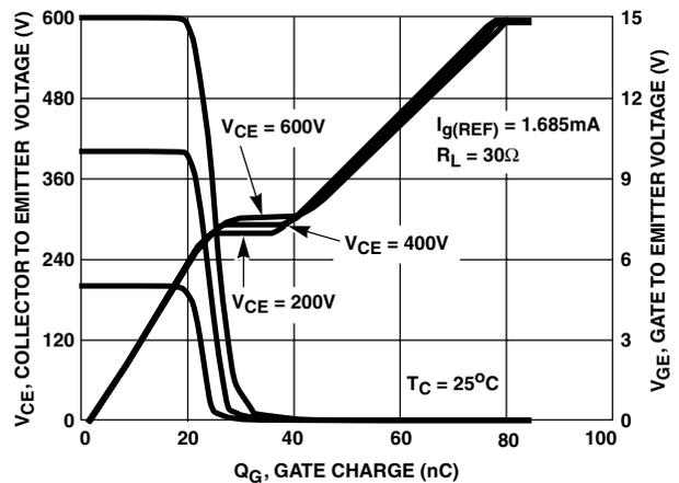
FIGURE 6. GATE CHARGE WAVEFORMS
