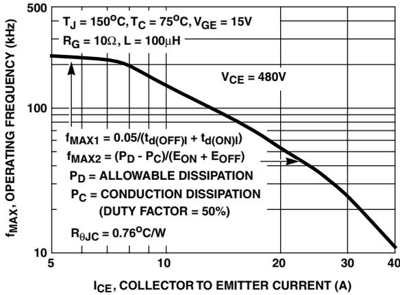
FIGURE 13. OPERATING FREQUENCY vs COLLECTOR TO EMITTER CURRENT
