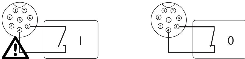
**An die Kontakte 4 und 5 darf keine Spannung angelegt werden.**
