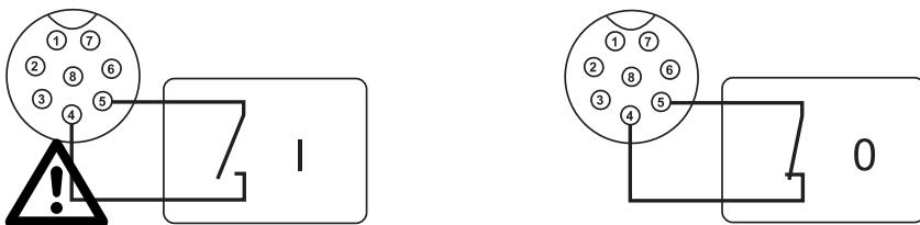
**Aucune tension ne doit être mise sur les contacts 4 et 5.**
