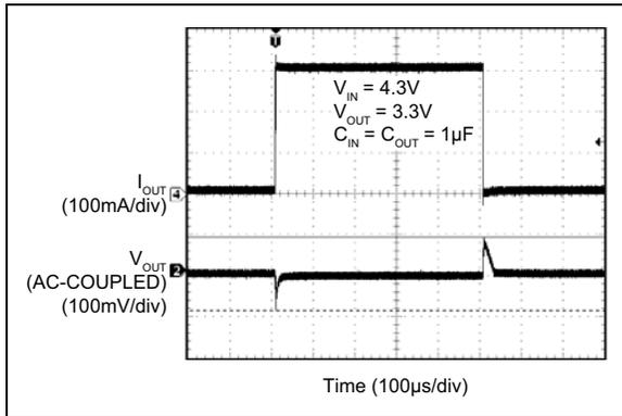
**FIGURE 2-14:** Load Transient.
