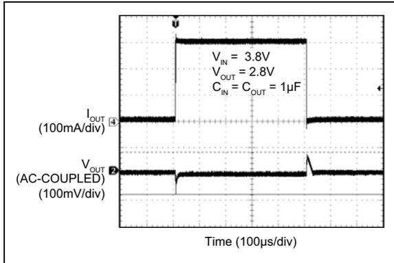
**FIGURE 2-13:** Load Transient.
