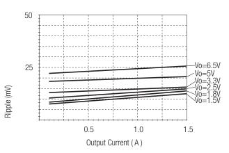
Ripple Vs Load (Vin=Max)
