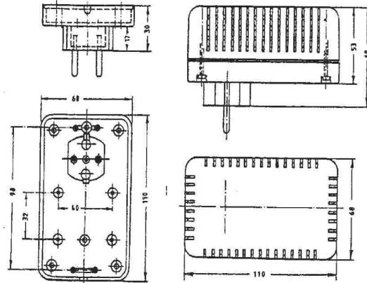
Kunststoffgehäuse mit angespritztem Stecker für deutsche 220 V Steckdose aus antistatischem, schlagfestem, flammhemmendem Kunststoff (UL 94 V0)
